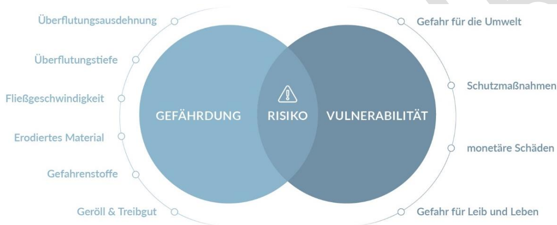
Abbildung 4-1: Gefährdung und Vulnerabilität als prägende Einflussfaktoren des Risikos (Eigene Darstellung, Datengrundlage: (LUBW, 2020))
